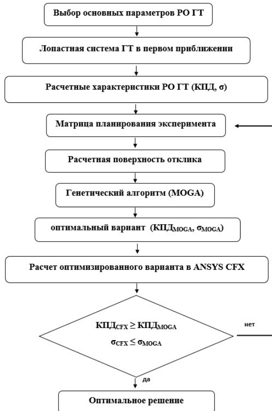
Рис. 1. Схема алгоритма проектирования РО ГТ Fig. 1. Flowchart of the design algorithm Francis turbine
