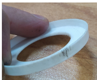
Рис. 2. Образование трещин в процессе механической обработки Fig. 2. Formation of cracks during machining
