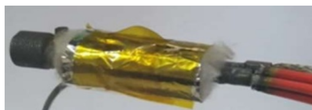
Рис. 3. ЭТМД с двумя АНЭ и теплозащитой
