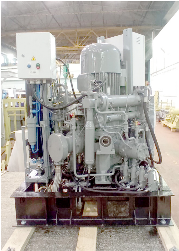
Рис. 1. Станция компрессорная автоматизированная СКА 60/200
