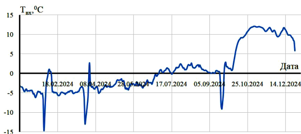
Рис. 6. График изменения температуры на входе в конденсатопровод Fig. 6. Graph of temperature change at the inlet of the condensate pipeline
