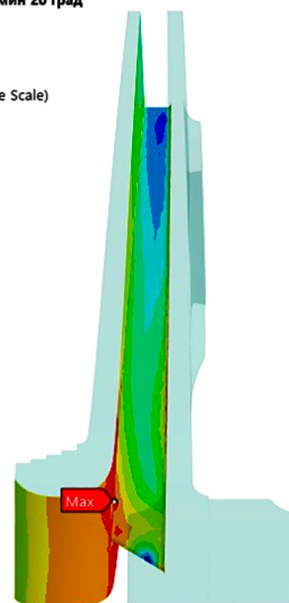
Рис. 6. Эпюра касательных напряжений (рабочее колесо) Fig. 6. Tangential stress diagram (impeller)
