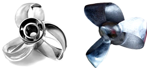
Рис. 3. Петлевидные гребные винты: а — гребной винт Sharrow [12]; б — петлевидный гребной винт [11]
