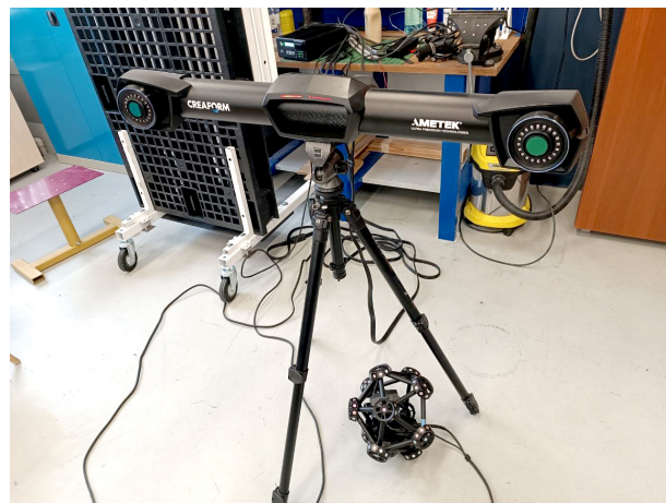
Рис. 2. 3D-сканер марки CREAFORM Fig. 2. CREAFORM 3D-scanner
