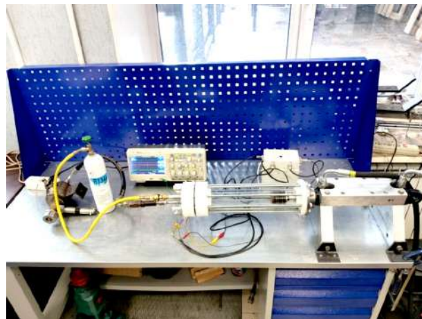
Рис. 6. Общий вид стенда испытаний тихоходного компрессора с двухфазным рабочим телом Fig. 6. General view of the test bench for a low-speed compressor with a two-phase working fluid
