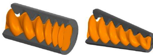
Рис. 8. Твердотельные модели рабочих органов винтовой машины: а — постоянный профиль и переменный шаг винтов; б — переменный профиль и постоянный шаг винтов
