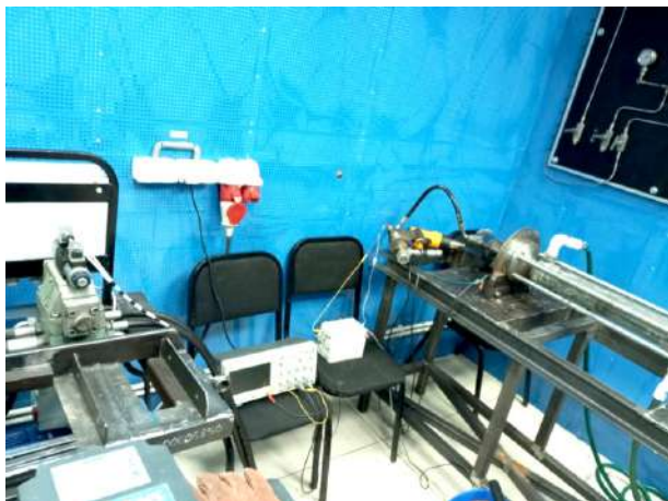
Рис. 1. Общий вид стенда испытаний с повышенной температурой на всасывании Fig. 1. General view of the test bench with elevated suction temperature
