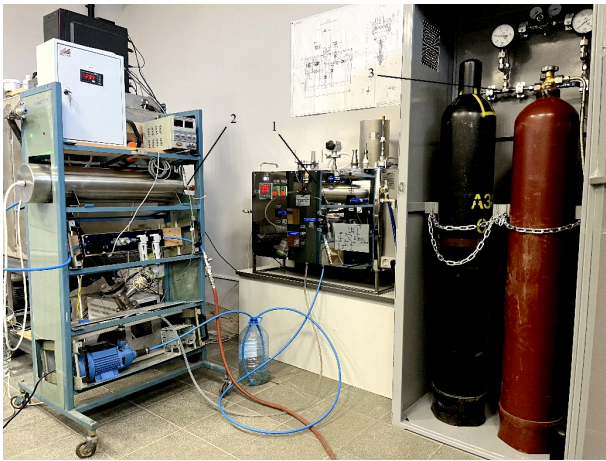
Рис. 2. Экспериментальный исследовательский стенд: 1 — стойка с ЭЁ, акустическими излучателями и метрологическим оборудованием; 2 — стойка с системой подготовки теплоносителя (газа) и системой подачи жидкости в ЭЁ; 3 — рампа баллонная с установленными баллонами с азотом и гелием
