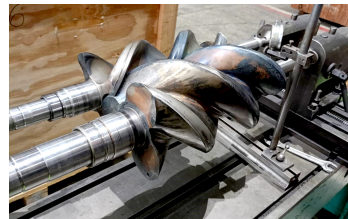
Рис. 6. Ротор винтового компрессора марки Aerzen, Z_1/Z_2 = 3/4 :
