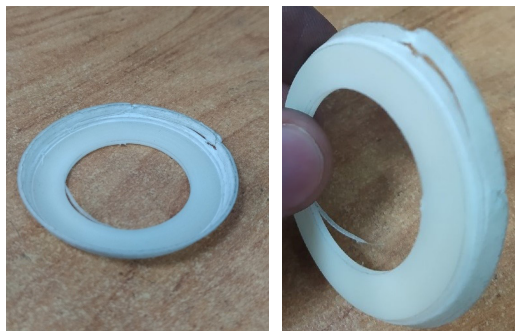
Рис. 1. Пример разрушения манжетного уплотнения от давления газа Fig. 1. An example of the destruction of the lip seal from gas pressure
