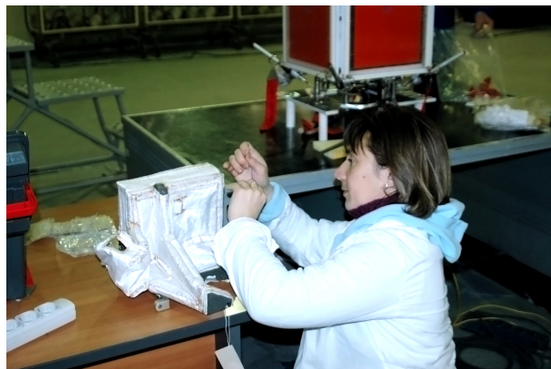
Рис. 7. Швейное изделие ракетно-космической техники — теплоизоляция спутника
