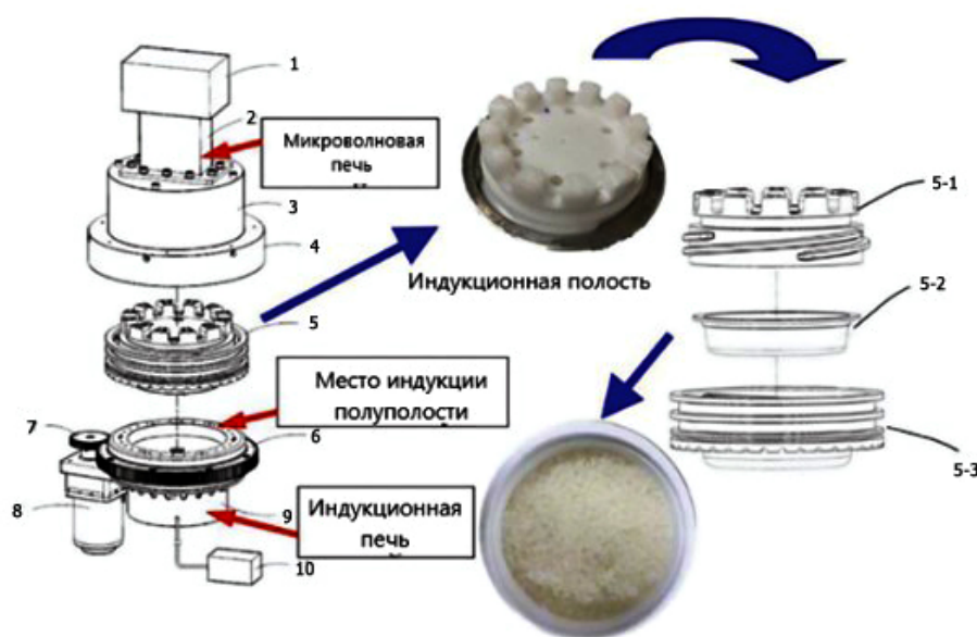
Рис. 5. Схема реактора двухстадийного нагрева (ИН и МВН):
