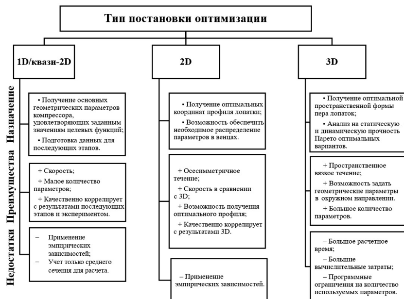
Рис. 5. Результирующая схема к подходам по оптимизации осевых компрессоров Fig. 5. Resulting scheme to approaches for the axial compressors optimizing
